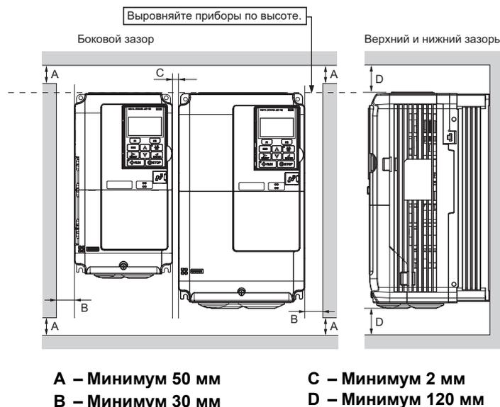
**Рис. 2.3** Расстояние между преобразователями частоты (монтаж "стенка к стенке")
