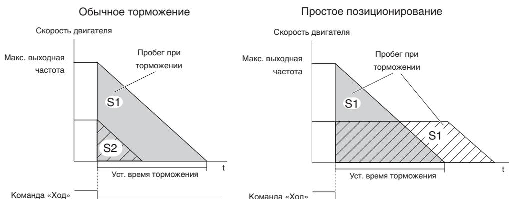
Рис. 5.8 Торможение с простым позиционированием
