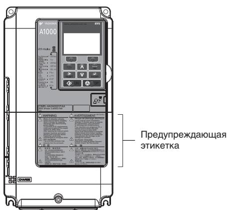
Рис. i.3 Положение предупреждающей этикетки
