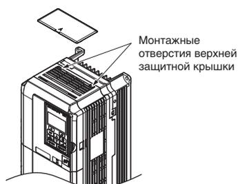
Рис. 3.19 Установка верхней защитной крышки
