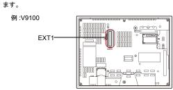
CUR-08 の取付穴 3 カ所を V シリーズまたは TS2060i の取付穴 3 カ所と合わせて、 下図Aの場所を上から軽く押します。コネクタがしっかり嵌合したことを確認し ます。
