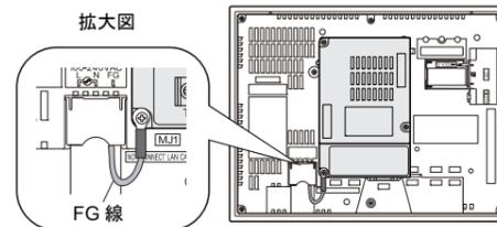
\* TS2060iの場合は、通信用FG端子にFG線を接続してください。
