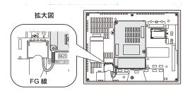
\* TS2060i の場合は、通信用 FG 端子に FG 線を接続してください。
