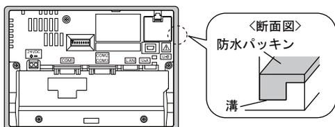
3. 板金パネルに取り付け、TS1000 Smartシリーズ付属の取付金具4個で固定します。
