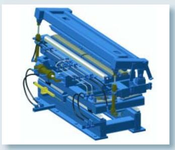
В зоне подачи непрерывных линий обработки полосы конец и начало полосы соединяются. Это осуществляется посредством сшивных или сварочных машин в зависимости от материала полосы, ее толщины и конструкции установки.
