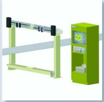
Прецизионное индуктивное устройство ЕМІ для измерения оси и ширины полосы
