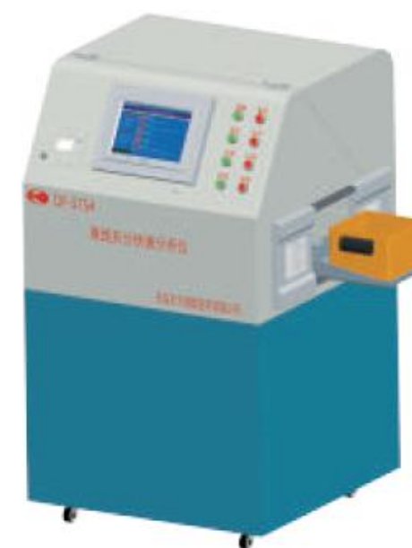
Рис. 1.1 Оффлайн-экспресс-анализатор зольности DF-5754
