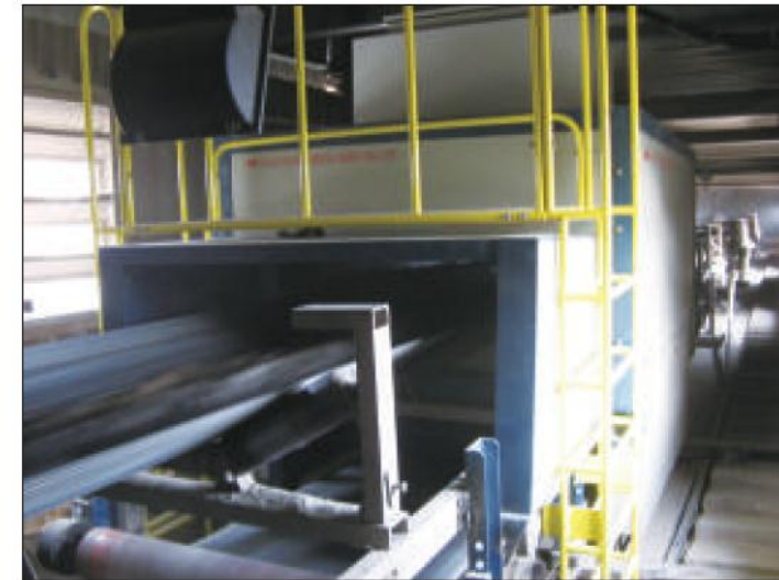
Рис.8 площадка анализатора, использованного в автоматическом управлении шихтовки сырья
