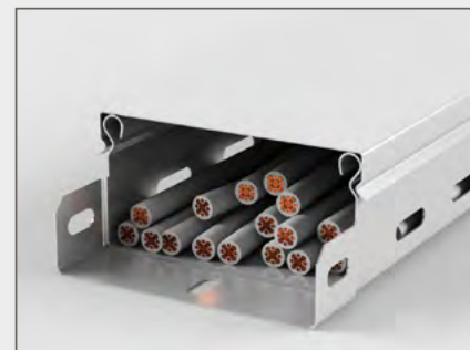
Неофициальное правило/наблюдение — при заполнении лотка на 50%, кабели, свободно размещённые в лотке, занимают всё пространство лотка.
