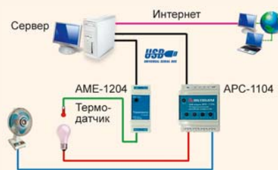
Рис. 1. Схематичное изображение стенда «Тест-драйв модулей автоматизации и управления»
